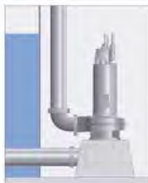
CT - Installation permanente en position verticale, hors d'eau ou immergée, avec brides de raccordement sur les conduites d'aspiration et de refoulement.
